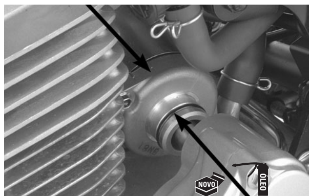
ANEL DE VEDAÇÃO CABO DO TERRA
